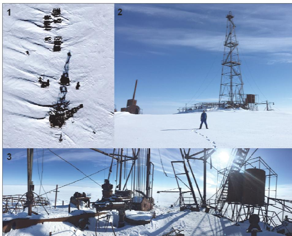
Рис. 7. Брошенная скважина с буровым оборудованием на полуострове Ямал: 1) вид из космоса (WV-2 18.04.17), 2) и 3) фотографии на месте (И.В. Богоявленский 01.04.2017)
