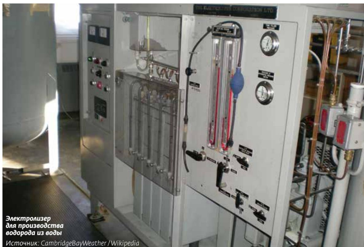
Электролизер для производства водорода из воды
