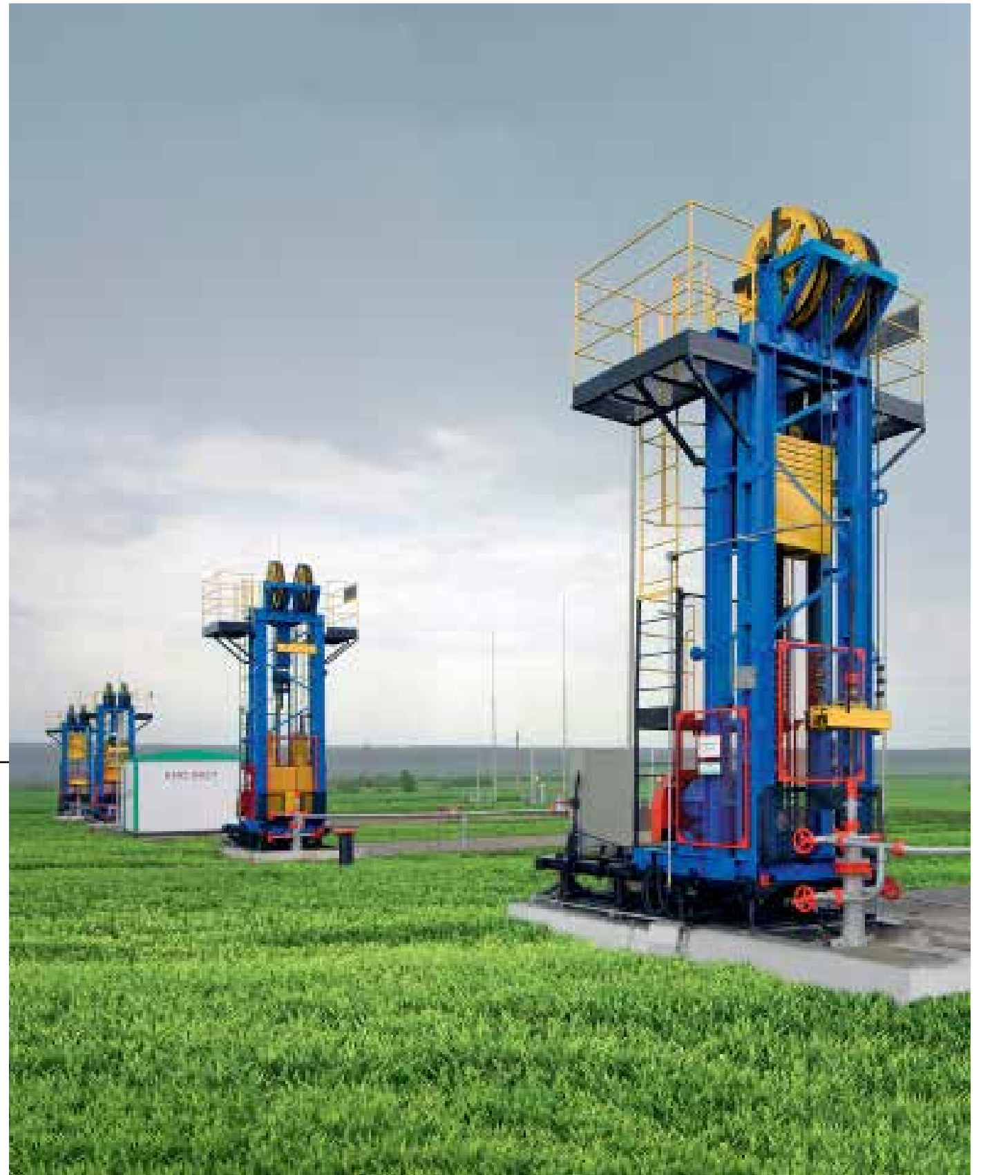
Цепной привод на Ромашкинском месторождении Источник: ПАО «Татнефть»
