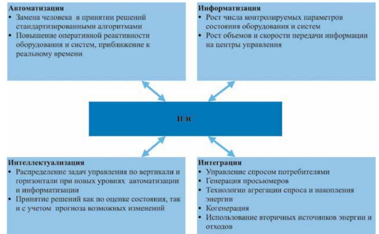
Рис. 4. Изменение систем управления технологическими процессами и рыночными операциями в ИЭС
