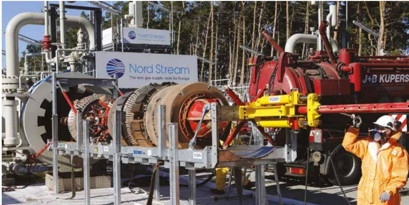
Диагностика газопровода «Северный поток» при помощи интеллектуальных поршней
