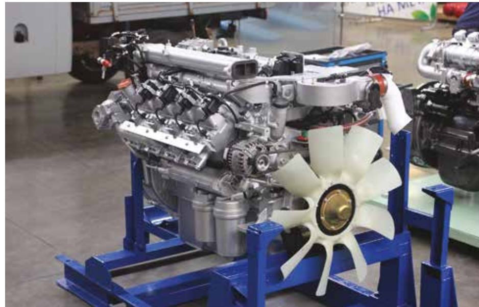
Газовый двигатель КАМАЗ 820.92-300 Источник: himpribor-reaktiv.ru
