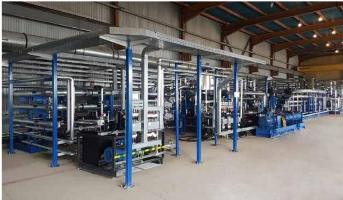
Рис. 8. Стенд для проведения многофакторных исследований характеристик АСГС нефти и нефтепродуктов
