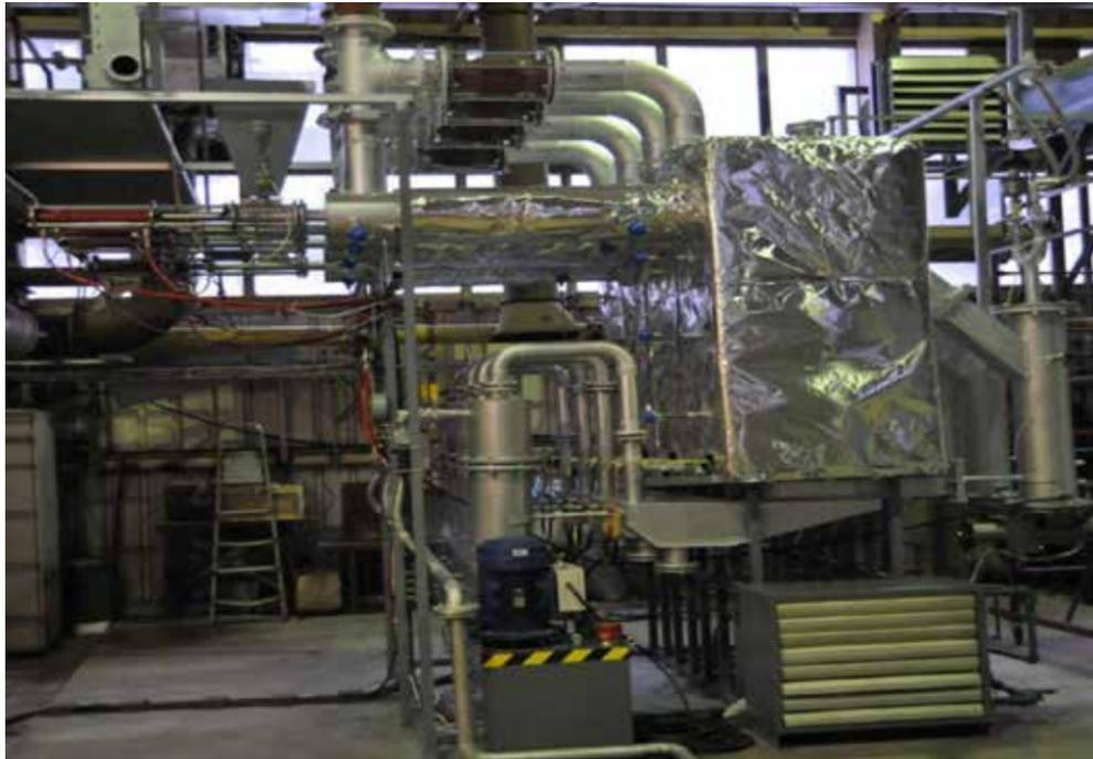
Рис. 1. Установка ОИВТ РАН по отработке режимных параметров технологии конверсии местных топливно-энергетических ресурсов в газовое топливо. Мощность – 50 кВт эл.
