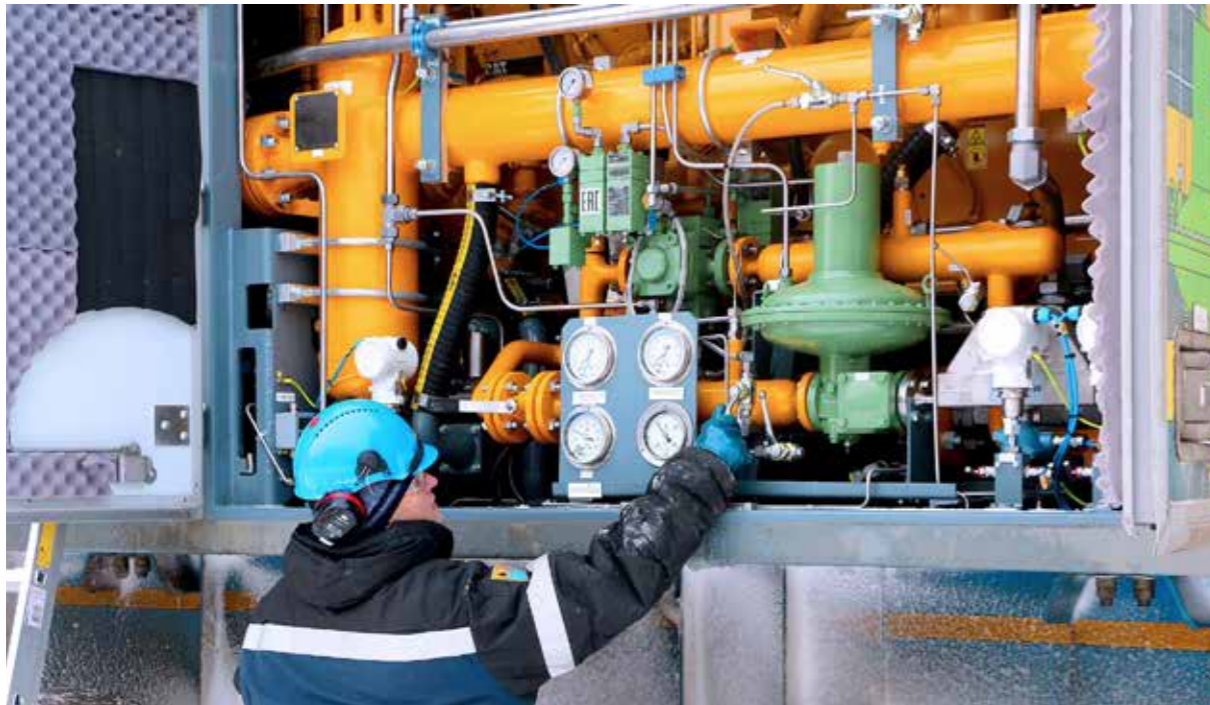
Мобильная компрессорная станция
