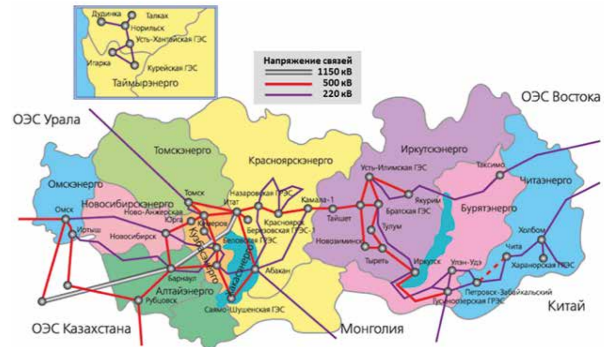
Рис. 1. Схема основных электрических сетей ОЭС Сибири
