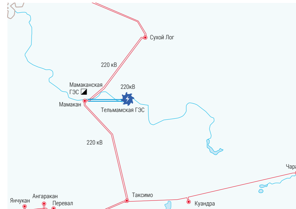
Рис. 3. Схема расположения и подключения Тельмамской ГЭС с Бурятской энергосистемой
