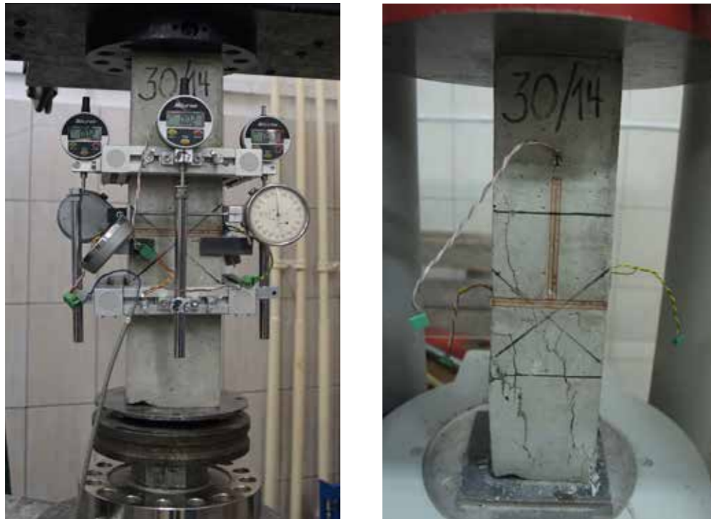
Рис. 2. Образец в испытательной машине до и после испытания
