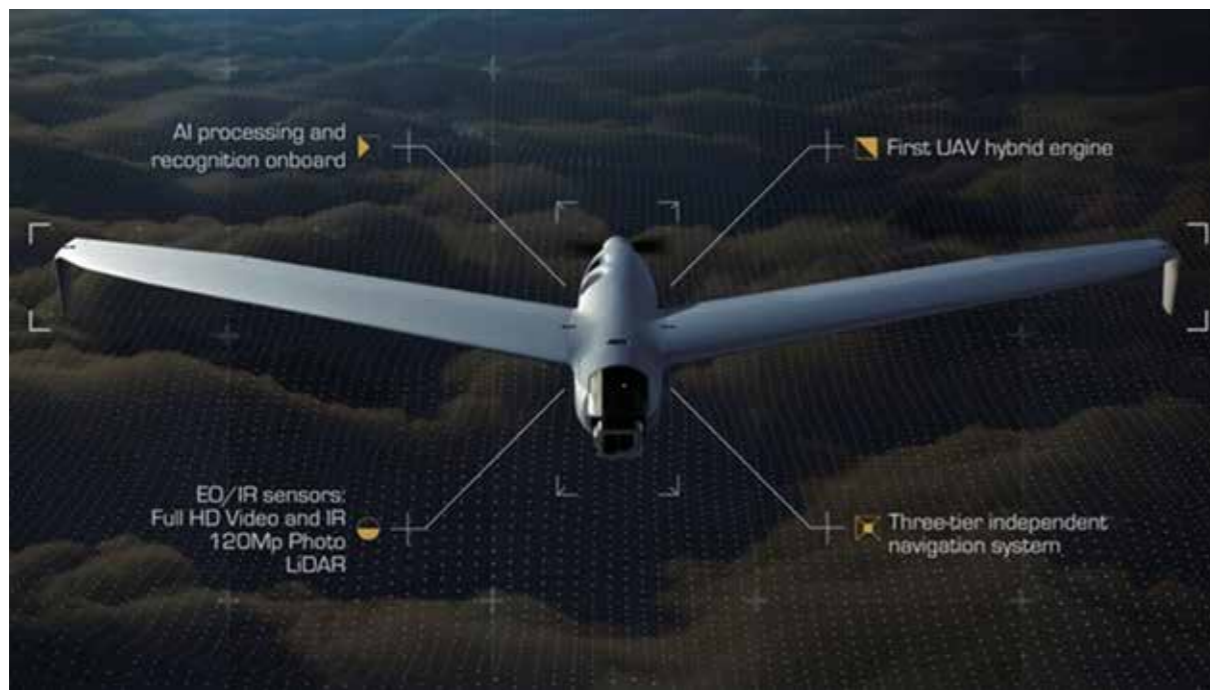
Рис. 5. Российский гибридный БВС ZALA 421–16E5G продемонстрировал полёт на 12 часов, расстояние более 1130 км
