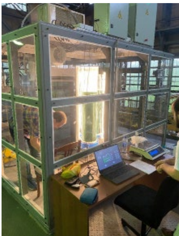
Рис. 4. ФБР объемом 90 л для наработки биомассы микроводорослей в условиях высокой концентрации \text{CO}_2 (в атмосферной газовой камере)
