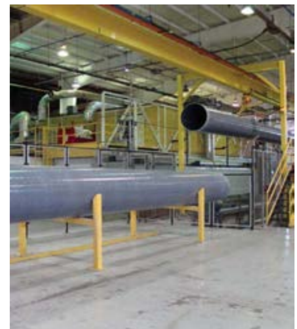
Рис. 2. Производство композитных труб
