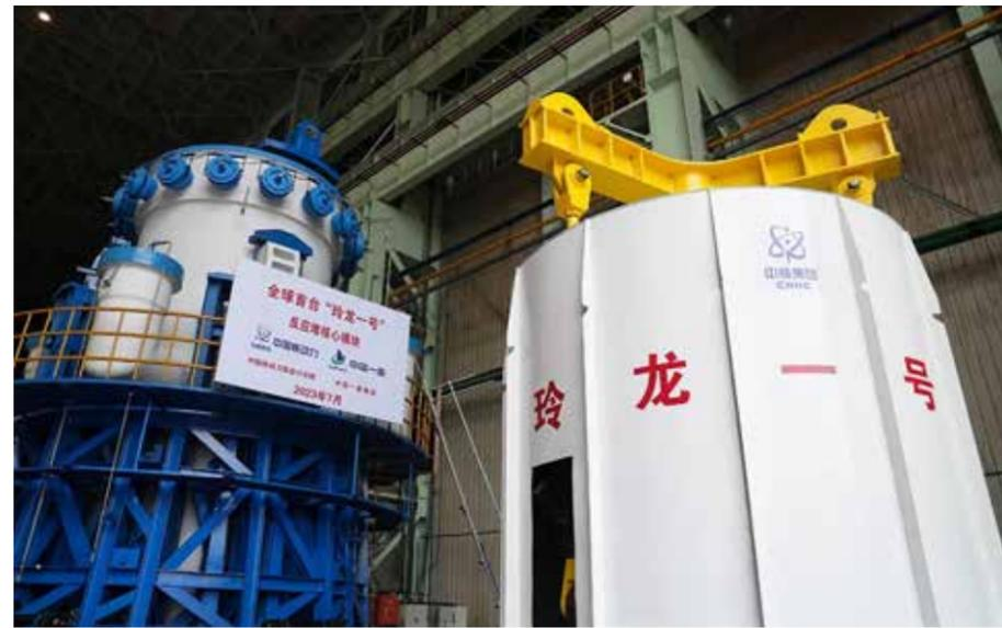
Атомный реактор малой модульной АЭС
